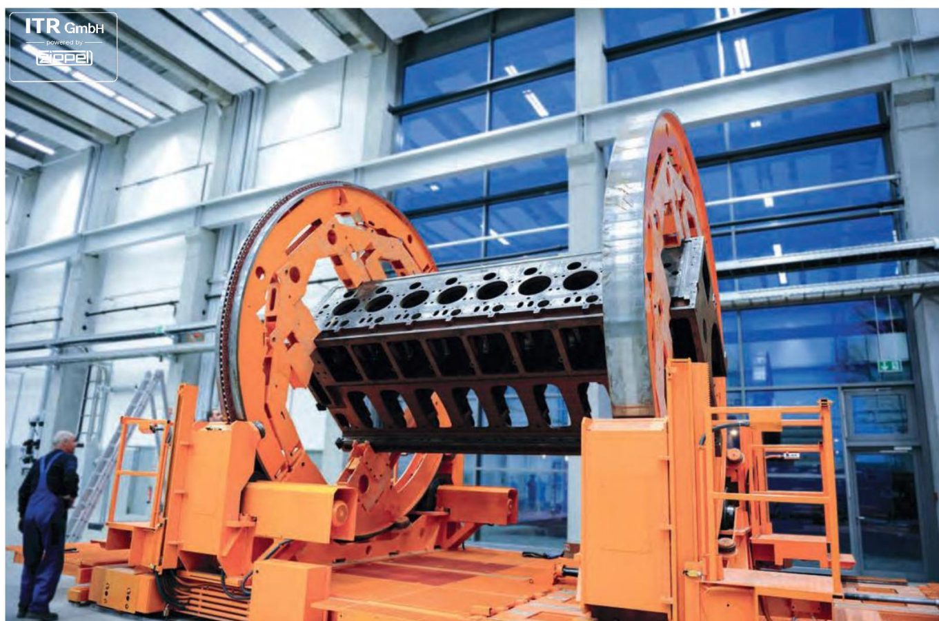
Transport- und Werkstückträger für Schiffsmotoren
