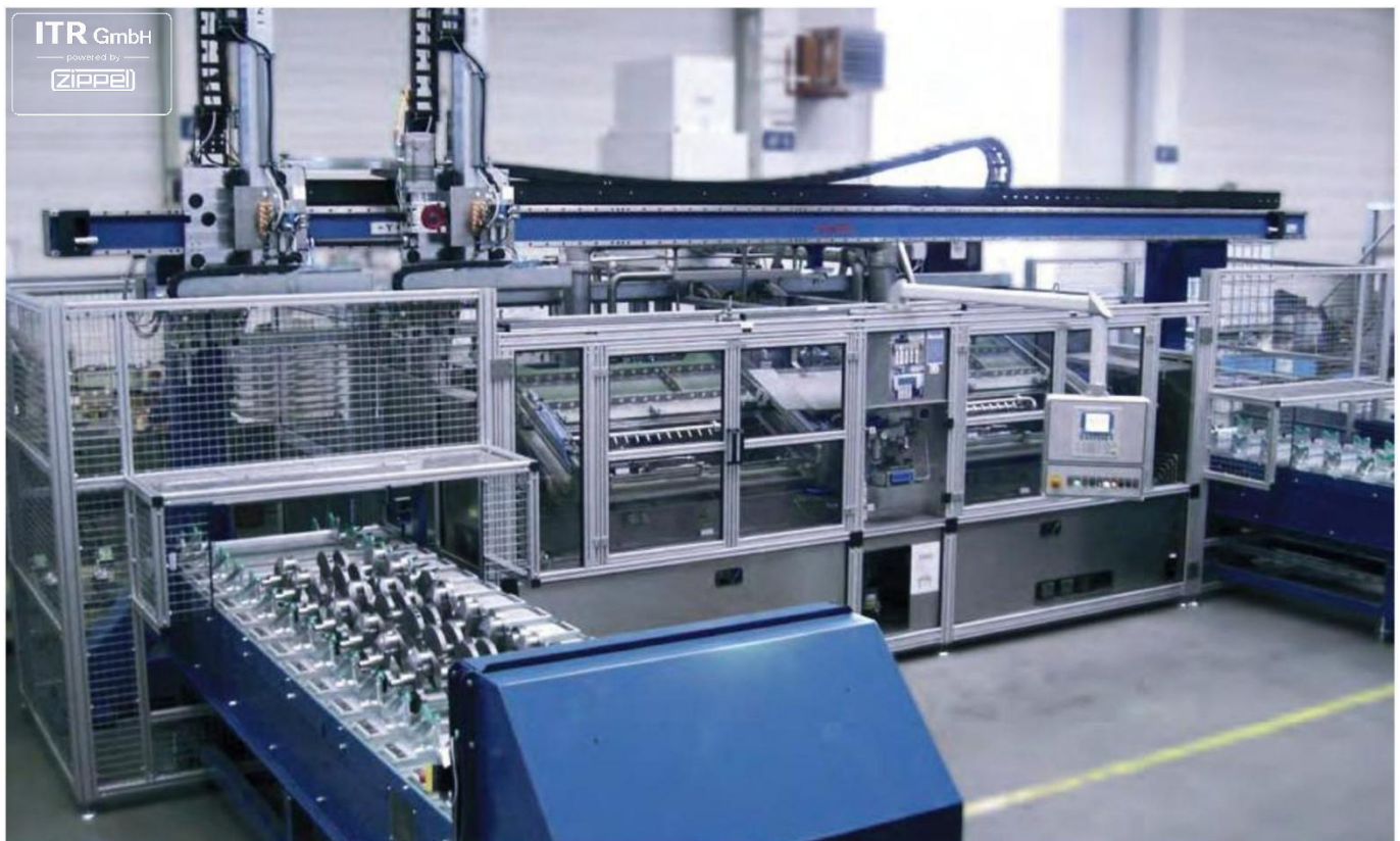
Reinigungsanlage für Kurbelwellen diverser Größen
