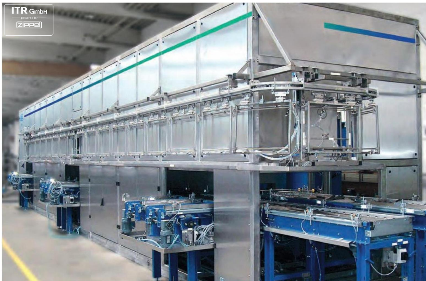
Durchlaufreinigungskombination mit Hängeförderer und Palettentransport
